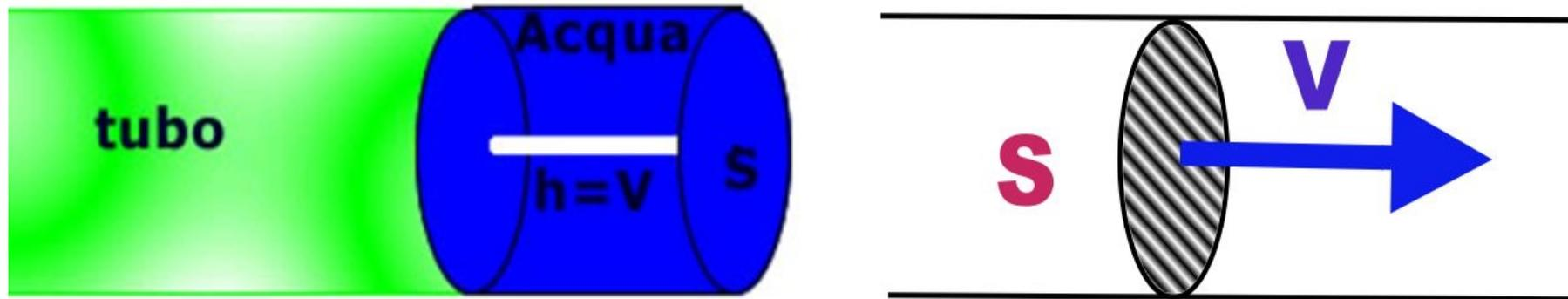
**Volume di fluido che attraversa una sezione della tubatura in un secondo.
