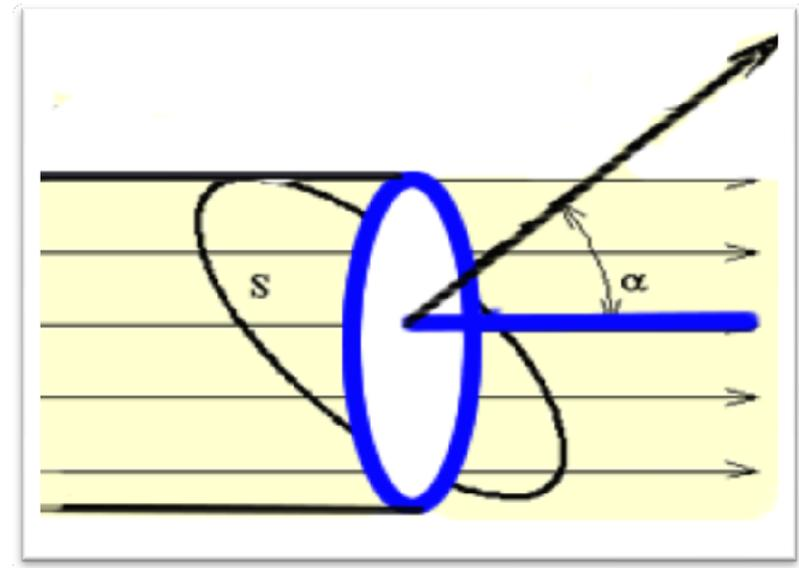
Se La superficie inclinata è  $S$ , l'area della superficie normale al moto  $S'$ , avrà un'estensione pari a  $S \cos \alpha$  e la portata allora varrà:
